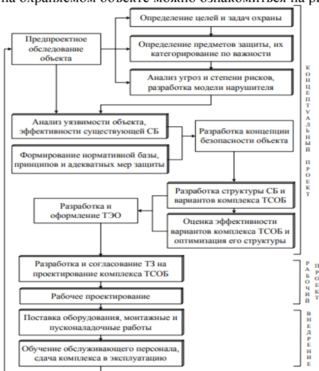
Рисунок 2– Структура жизненного цикла системы безопасности
