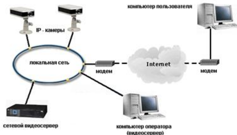
Рисунок 3 – Общая схема видеонаблюдения предприятий
